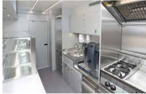
Spülbereich, Heißgetränke, Hygiene-Sicherheitsboden, Gewerbekühlschränke
